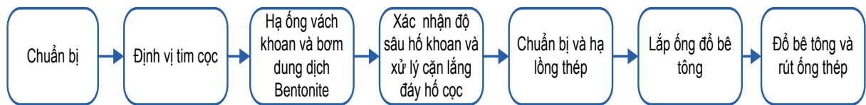
Hình 5: Quy trình thi công cọc khoan nhồi
